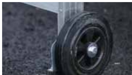
Mit zwei großen Rädern kann Tracker einfach über ebene und uneben Flächen fahren
