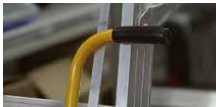
Ziehe den Griff auf sich zu und Navigator kommt in die mobile Position zum Fahren und Lenken
